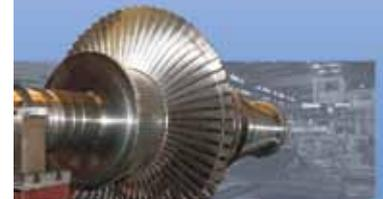
**Точные отливки лопаток
